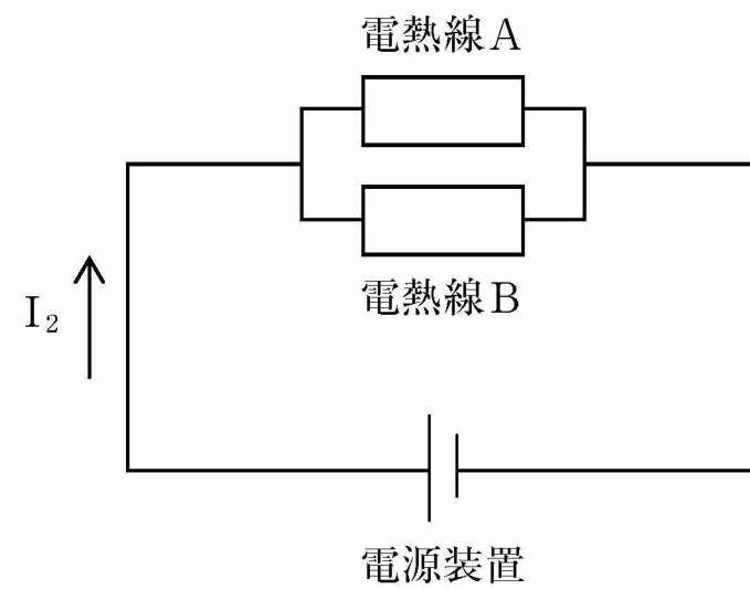
電圧の大きさと電流の大きさを測定する場合、電圧計は測定したい部分と A につなぎ、電流計は測定したい部分と B につなぐ必要がある。
